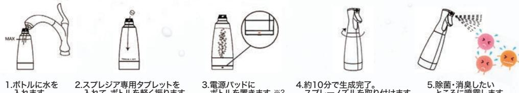
1.ボトルに水を入れます。 2.スプレジア専用タブレットを入れて、ボトルを軽く振ります。 3.電源パッドにボトルを置きます。<sup>※2</sup> 4.約10分で生成完了。スプレーノズルを取り付けます。 5.除菌・消臭したいところに噴霧します。
